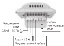
Рисунок 7. Схема подключения терморегулятора к сети
