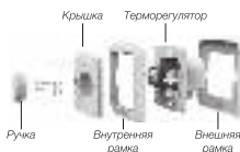
Рисунок 6. Терморегулятор в разобранном виде
